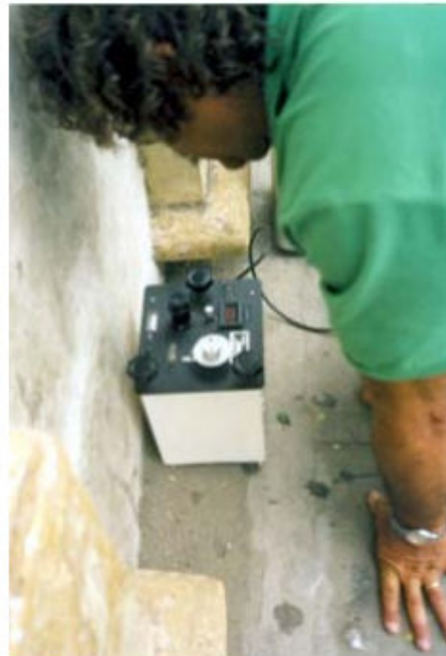
Foto 4 - Gravímetro La Coste & Romberg usado no campo
