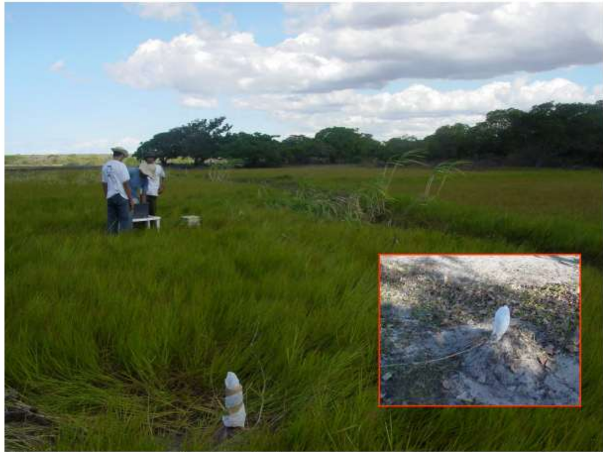
Figura 4.6.17. Instalação de um magnetômetro vertical.
