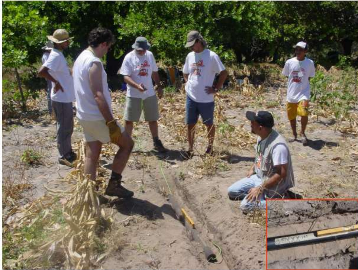
Figura 4.6.16. Instalação de um magnetômetro horizontal.
