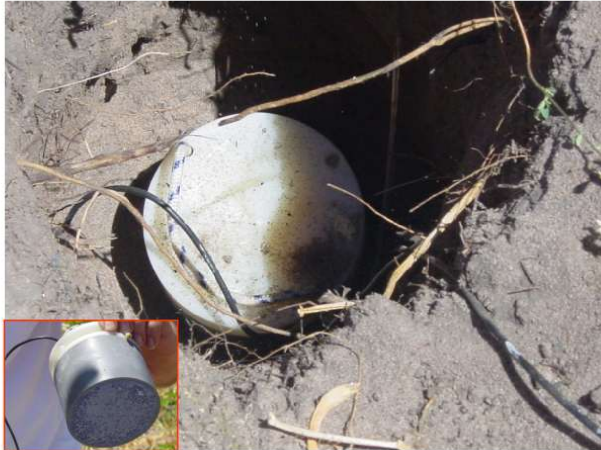
Figura 4.6.18. Instalação de um eléctrodo.
